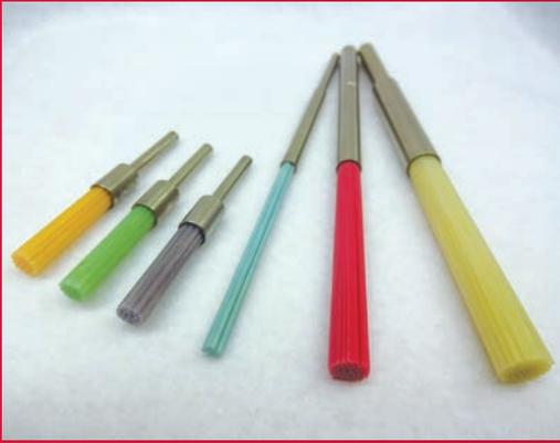
毛材にクリストンマトリックスを採用したブラシです。クリストンマトリックスはアルミナ長繊維とエポキシ樹脂からなる複合材でこれまで困難であったより硬いワークのバリ取りや研磨に最適です。ピンポイント用は回転を与えてもブラシが広がらず、正にピンポイント用です。交差穴用は回転でブラシが広がり、交差穴などの側面のバリの除去が可能です。
