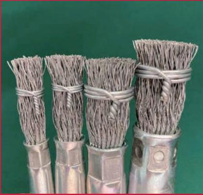
φ0.3mmの硬鋼線を亜鉛メッキした毛材を使用。研削力があり折損率が低く、高耐久性のブラシです。ブラシを結束し、先端が確実にワークを捉えますのでバリ取り、錆取り、溶接のビート除去に最適です。
