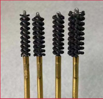
ファイバー樹脂に焼結した炭化ケイ素（SC）の砥粒玉を付けたものです。ファイバー樹脂は弾力性に富み凹凸型のワークにもよくなじみ研磨ムラが出にくいのが特徴です。粒度に合わせてバリ取り、錆取りにも最適です。
