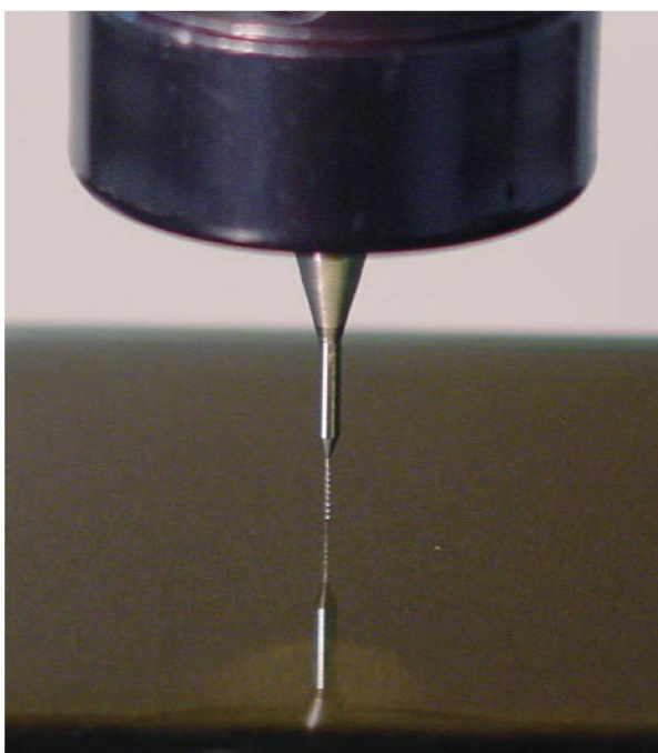
穴加工 回転数: 38,000\text{min}^{-1} 工具: \phi 0.15 \times 2.5 超硬ルーマー型ドリル 送り: F=960\text{mm}/\text{min} 材質: HPM1
