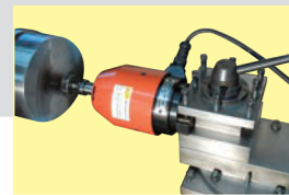
ツールポストアタッチメントを使用 しての汎用旋盤での内径研削削
