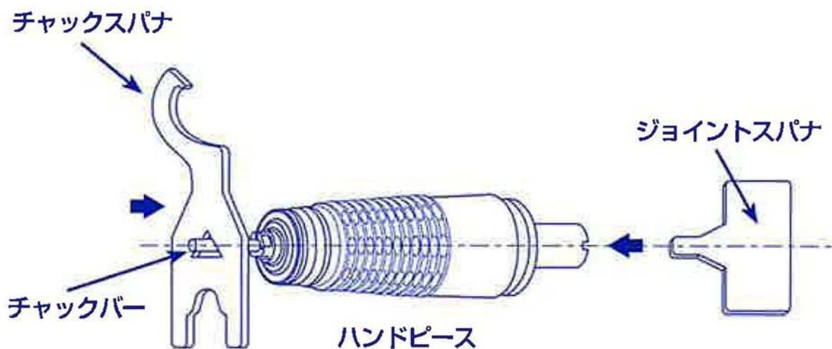
交換するコレットチャックに合った、チャックバーが無い場合は工具をコレットチャックに差し込んで締付けてください。
