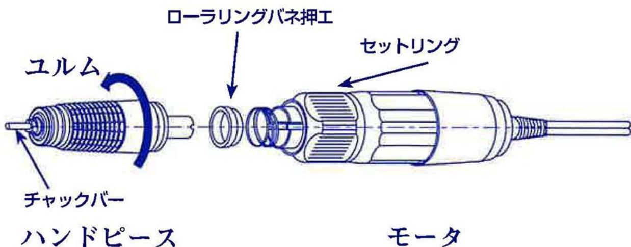
（ローラリングバネ押エはハンドピース内に組み込まれています。方向に注意して組付けてください。）
